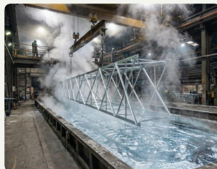
06 Galvanisation à Chaud
