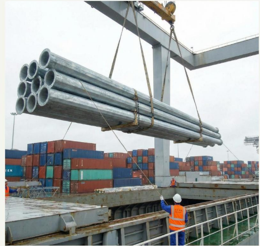
Carga de secciones de torre en buque de carga fraccionada (Breakbulk) — Puerto de exportación, China
