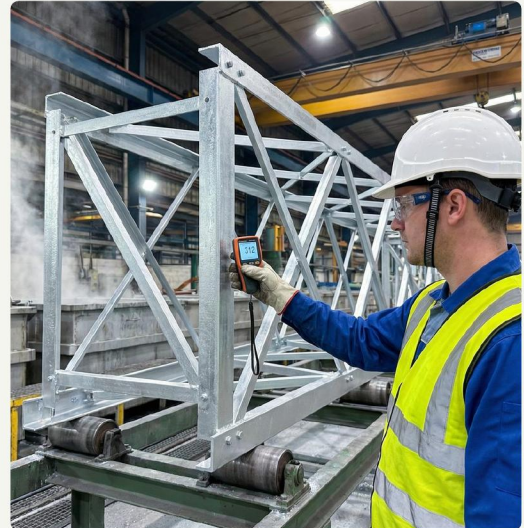
Inspector QC midiendo espesor de galvanizado ( \geq 86 \mu\text{m} )
